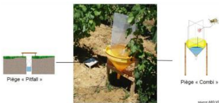
Fig.3 Système de piégeage par la méthode RBA, permettant la capture d'insectes rampants avec le piège Pitfall et d'insectes volants par le piège Combi.
